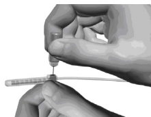
Figure 13 : Serrage de la vis de pression
