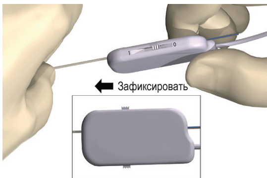
Рис. 10. Присоединение отведения для ГСМ к разъему кабеля для операционной 1 x 8
