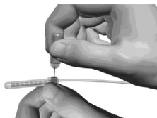
Obrázek 13: Utažení stavěcího šroubu
