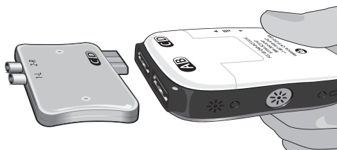
Рис. 8. Подключение адаптера ETS к внешнему пробному стимулятору 2
